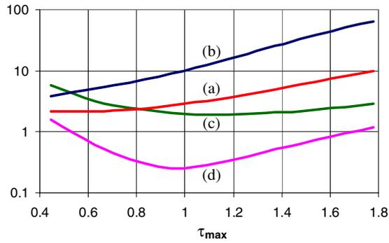
**Figure 3.** Relative standard deviations (%) of estimation errors in different parameters versus  $\tau_{\max}$ . (a)  $Rc$ ; (b)  $mc$ ; (c)  $a$ ; (d)  $\lambda$ .
