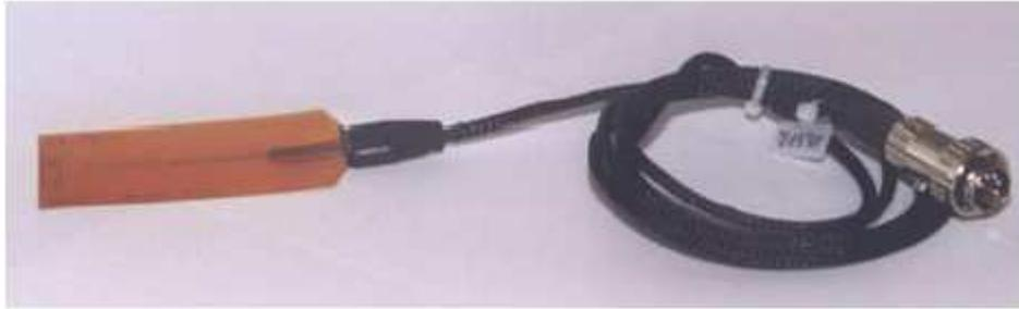
Figure 6.1 : Vue d'une sonde de type fil chaud
